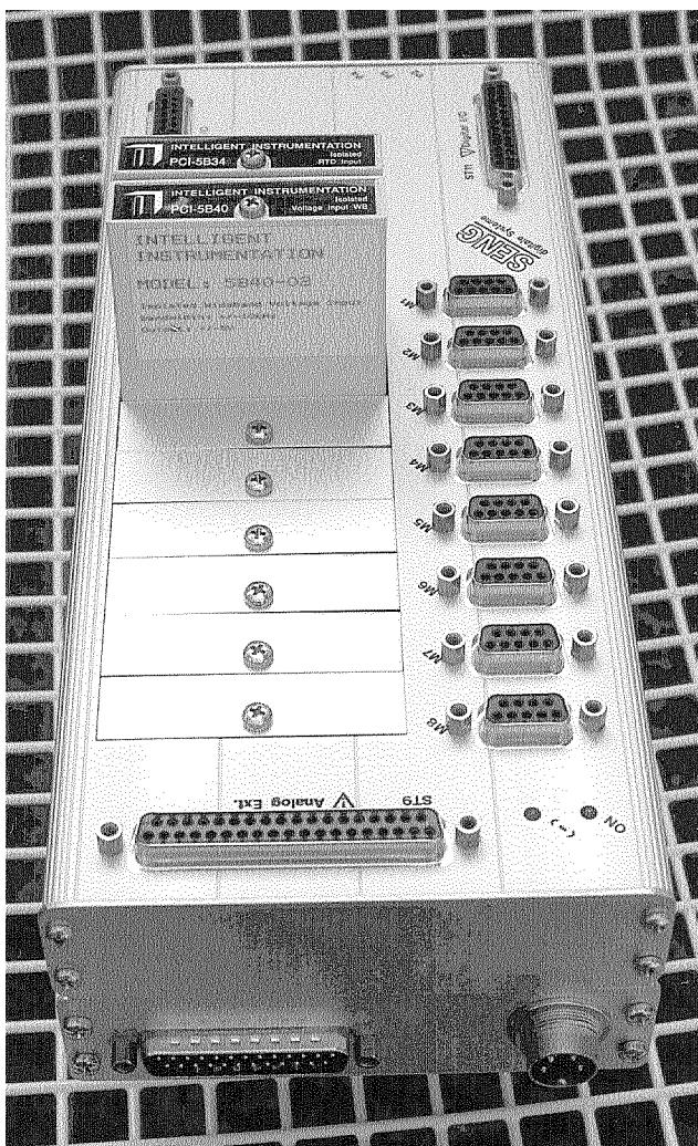
**5B Modul Erweiterungsbox für das AnaDigIO Grundgerät.** 5B-Module sind standardisierte analoge Messwertaufbereitungsmodule die galvanische Trennung des Messsignals, Langzeitstabilität und Verfügbarkeit garantieren.
